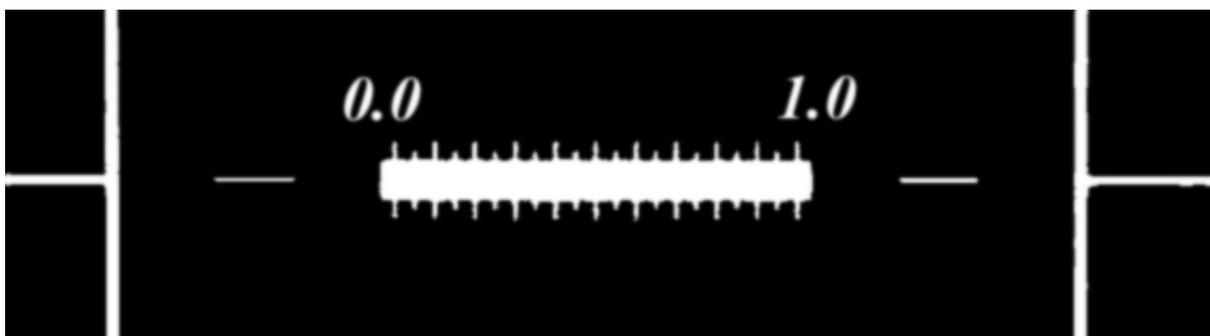
Рисунок 23 — Вид линейки объект-микрометра в проходящем свете
