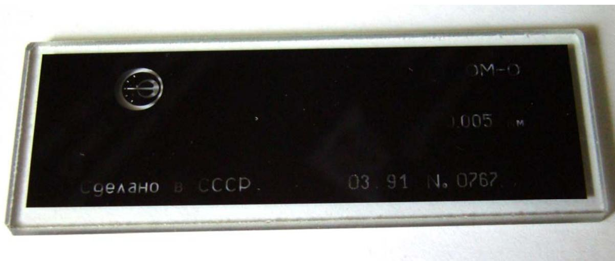
Рисунок 22 — Внешний вид объект-микрометра типа ОМ
